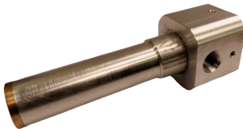
Рис. 4. Тестовый объект для измерений – узел системы жидкостного охлаждения рентгеновской трубки.
